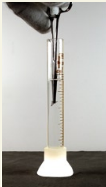
44. A minta triklór-etilén és triklór-etán keverékébe helyezése
