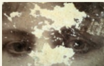
7. Lepakott kollódium- és baritréteg celloidin-fotográfián
